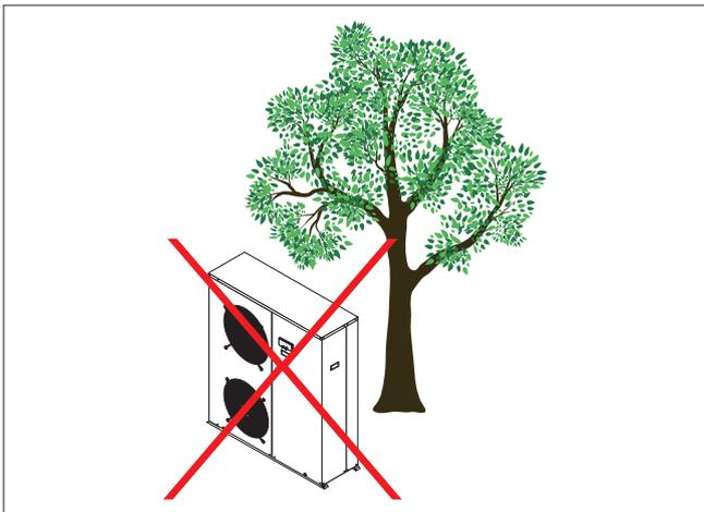
Instalar la unidad exterior asegurando la limpieza de la batería con aletas y de los ventiladores. Por lo tanto, no instalar el aparato cerca de arbustos que puedan afectar el correcto funcionamiento de la máquina con la caída de las hojas.
