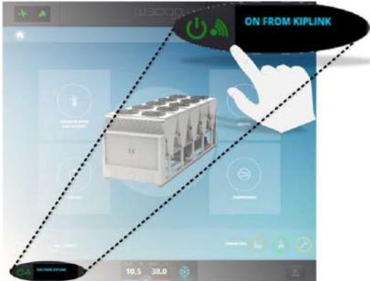
Seleccionando la función de ON/OFF aparecerá un Pop-Up que no permitirá apagar o encender la máquina ya que no se poseen las autorizaciones necesarias para poder desempeñar la función seleccionada.
