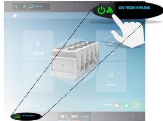
Seleccionando la función de ON/OFF aparecerá un Pop-Up que indicará que se debe seleccionar la opción deseada, permitiendo así el apagado/encendido de la unidad.
