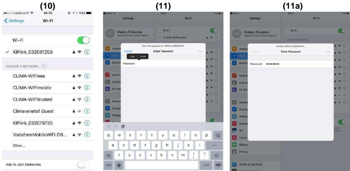
De esta forma el dispositivo se conecta con la red Wi-Fi del KIPLink.
