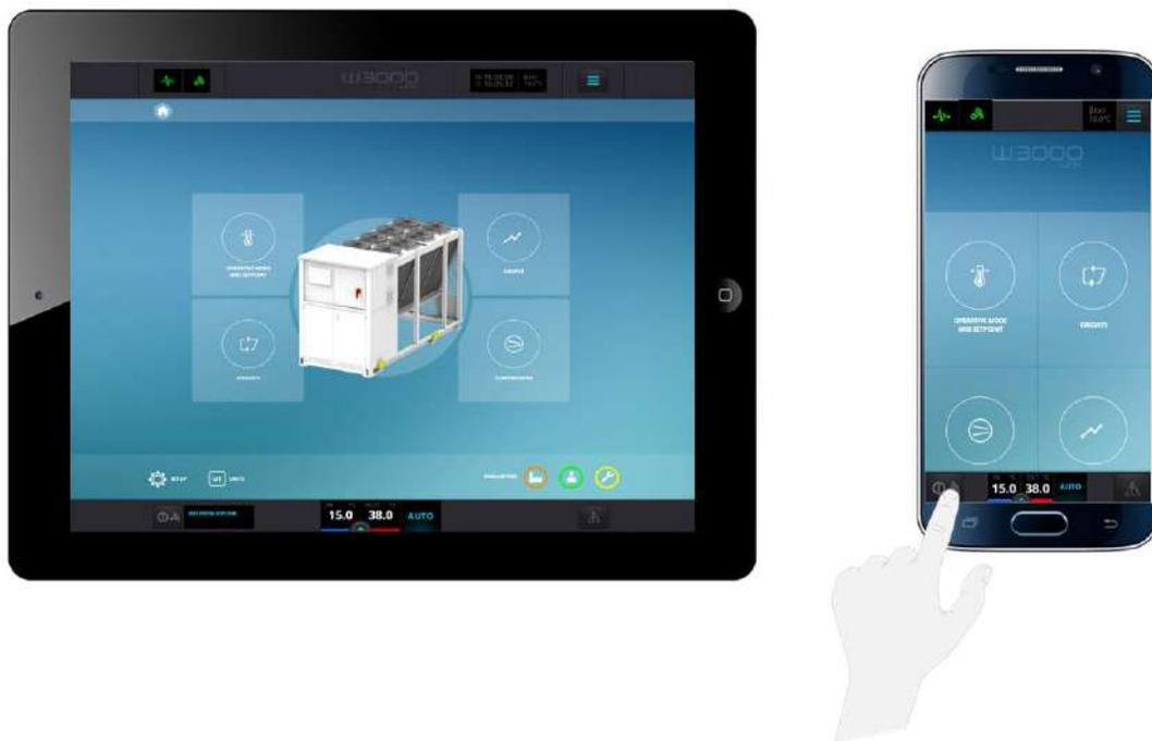
Aparecerá una pantalla en la que se puede confirmar el encendido con “Encender” o anularlo pulsando “Cerrar”. Para el apagado se debe seguir el mismo procedimiento.
