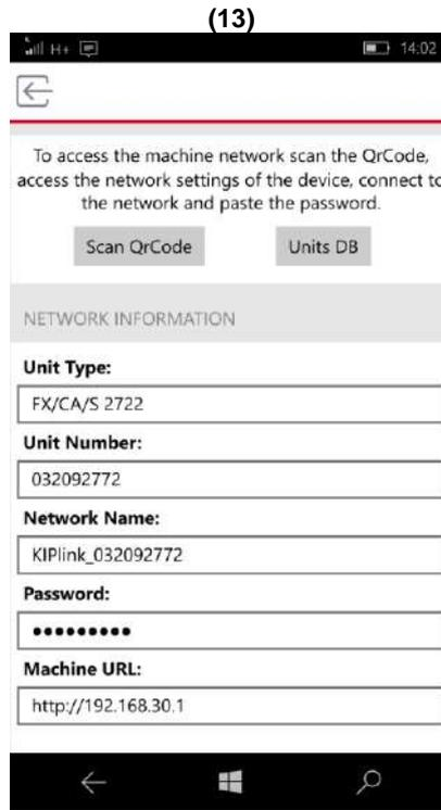
**i** Nota: La introducción manual se realiza mediante la línea de inserción que aparecerá seleccionando la opción introducción manual; esta acción se puede realizar siempre a condición de que se rellenen de forma apropiada las cadenas requeridas **(14)** y conectándose a la red Wi-Fi generada por el KIPLink asociado a la unidad **(15)**. Las tres informaciones necesarias para la conexión son:
