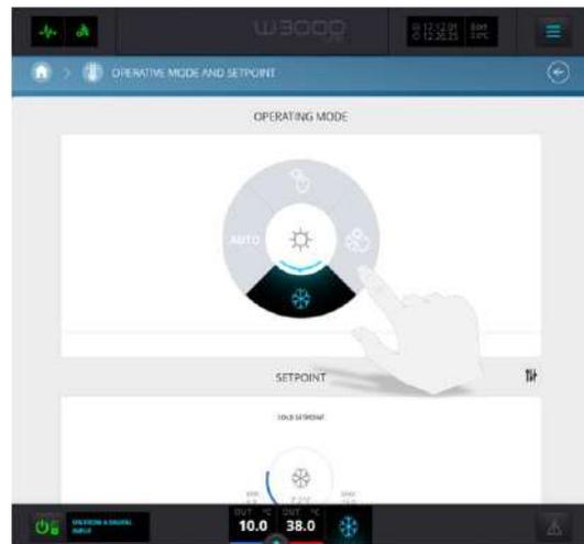
Haciendo clic en el modo de funcionamiento deseado aparece un Pop-Up que no permite cambiar el modo de funcionamiento por no ser un usuario habilitado para realizar dicha modificación.
