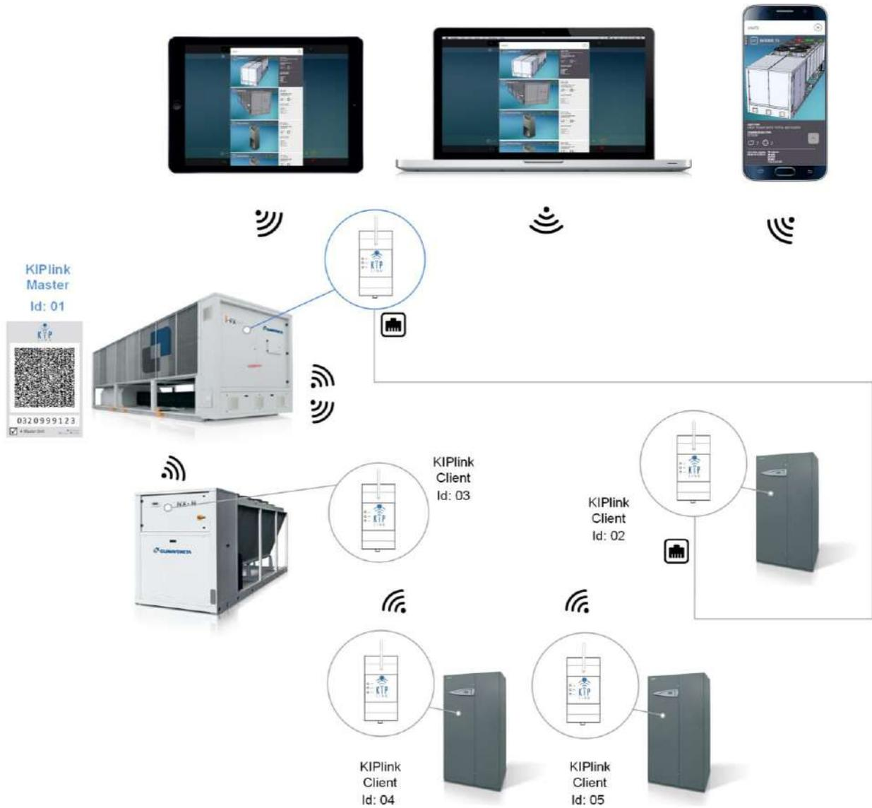
**i** Nota: para las unidades Client situadas en un radio que la red Wi-Fi creada por el dispositivo Master no puede alcanzar, extienda el radio de cobertura instalando el "KIT Antena Remota magnética KIPLink" o utilice dos KIPLink Earth (uno en la unidad Master y el otro en la unidad Client) conectados entre sí mediante una red ethernet.
