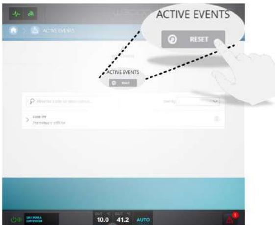
Seleccionando la tecla Reset aparecerá un Pop-Up que impedirá desempeñar correctamente la función Reset ya que, según lo descrito en el Pop-Up, no se poseen las autorizaciones necesarias para realizar el Reset de las alarmas activas.
